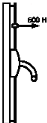
Рисунок В.1 – Схема приложения статической нагрузки к тягам устройства «Антипаника» для дверей эвакуационных и аварийных выходов
