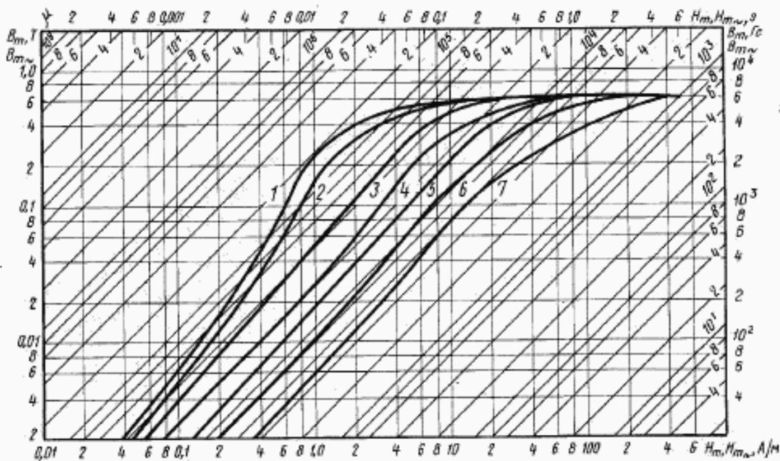
Кривые намагничивания сплава марки 80НХС толщиной 0,2 мм для частот:
