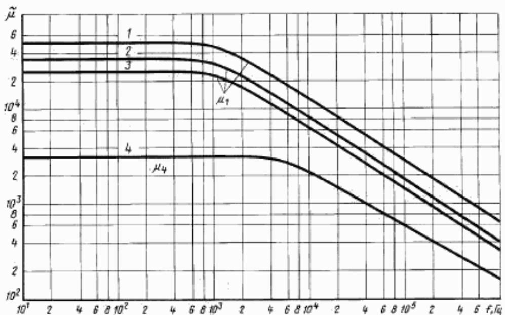
Зависимость  $\tilde{\mu}$  от частоты для сплавов в лентах толщиной 0,1 мм марок:
