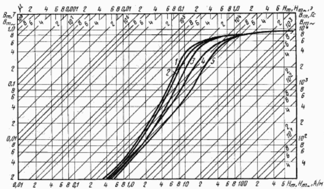
Кривые намагничивания сплава марки 50НХС толщиной 0,1 мм для частот:
