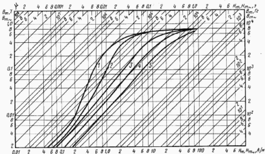
Кривые намагничивания сплава марки 79НМ толщиной 0,2 мм для частот:
