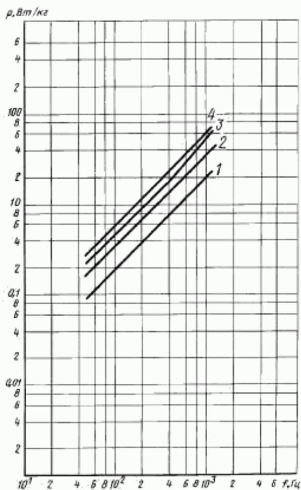
Зависимость удельных потерь от частоты для сплава марки 49К2ФА в лентах толщиной 0,1 мм (после термомагнитной обработки):
