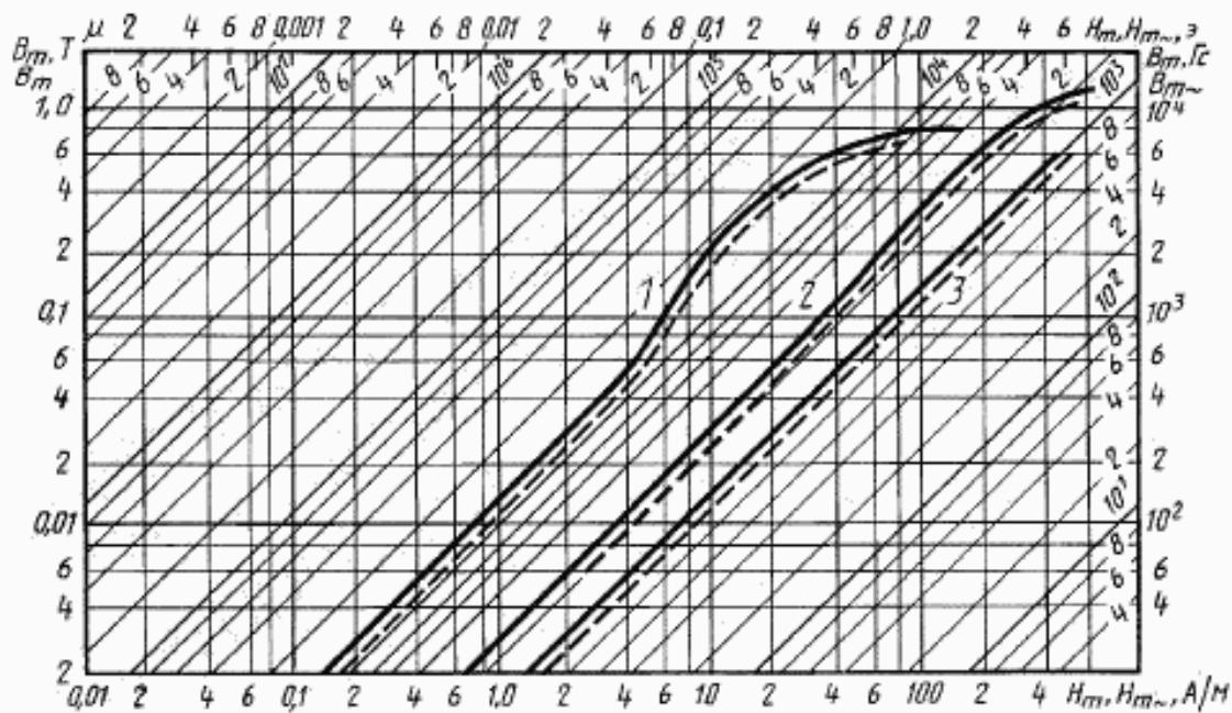
Кривые намагничивания образцов ленты толщиной 0,02 мм из сплавов марок 1—79Н3М, 2—64Н, 3—47НК.
