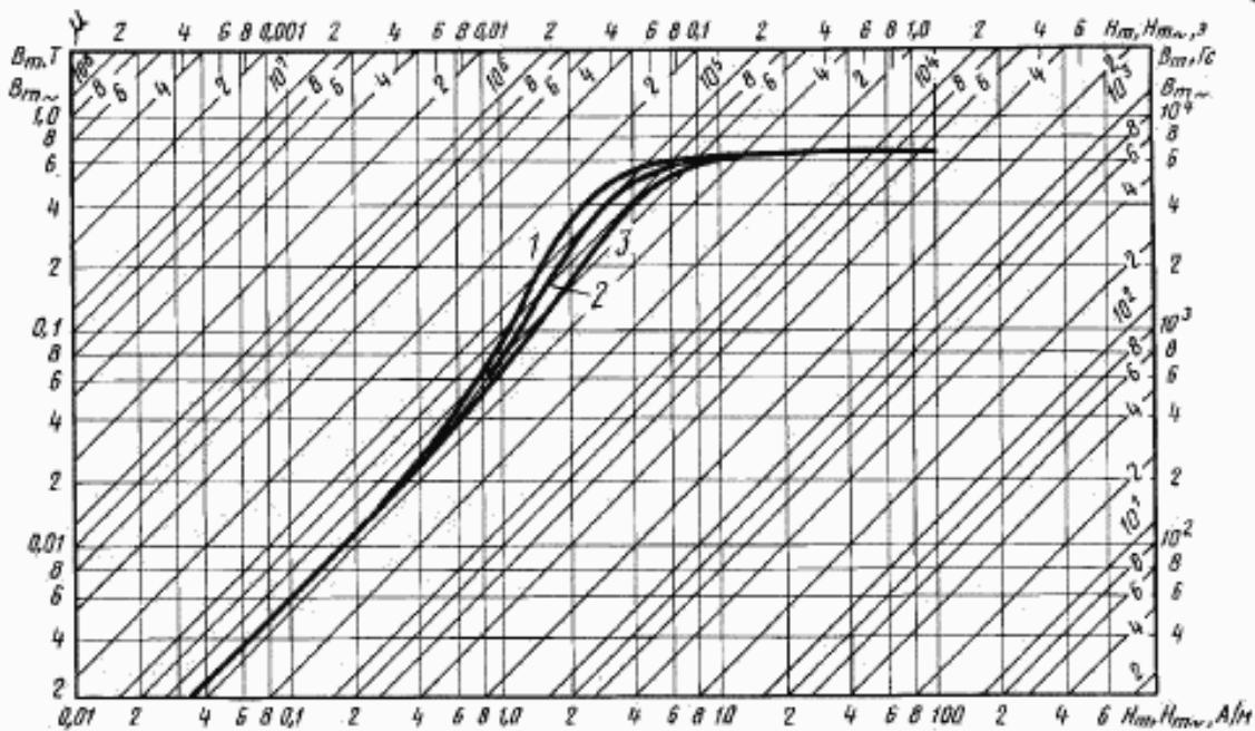
Кривые намагничивания сплава марки 83НФ толщиной 0,02 мм для частот:
