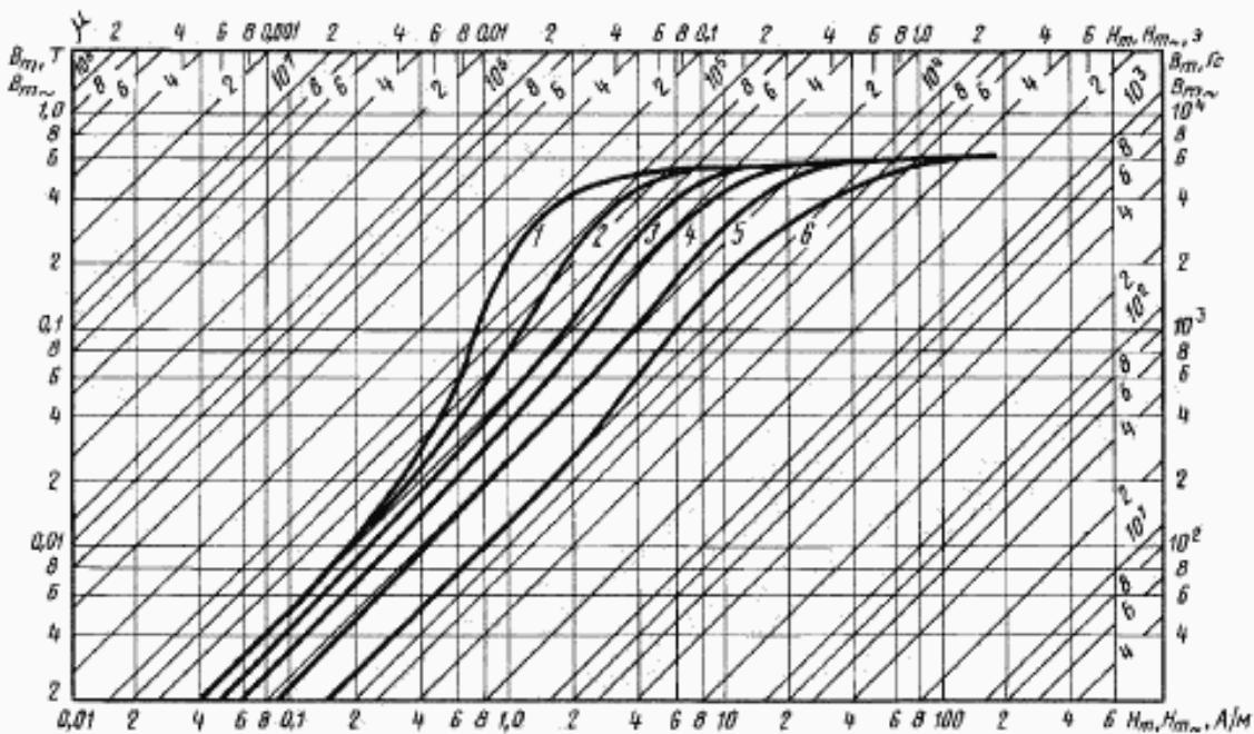
Кривые намагничивания сплава марки 80НХС толщиной 0,1 мм для частот:
