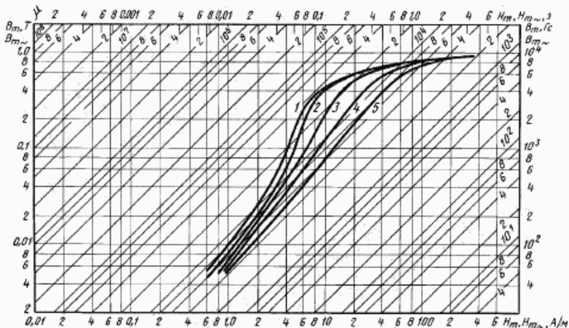
Кривые намагничивания сплава марки 50HXC толщиной 0,25 мм для частот:
