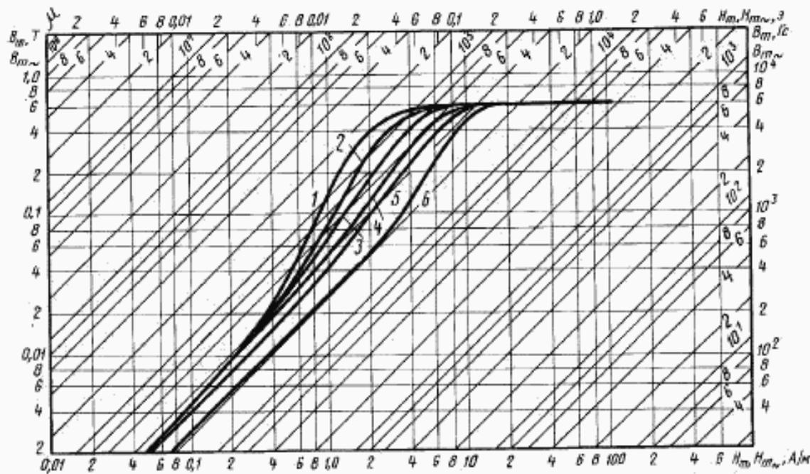
Кривые намагничивания сплава марки 80НХС толщиной 0,05 мм для частот:
