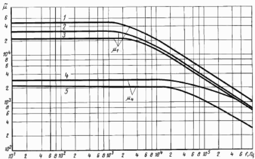
Зависимость  $\tilde{\mu}$  от частоты для сплавов в лентах толщиной 0,05 мм марок:
