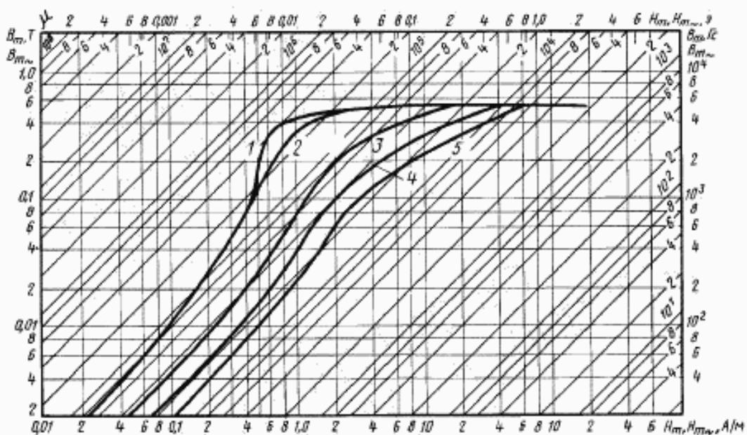
Кривые намагничивания сплава марки 81НМА толщиной 0,2 мм для частот:
