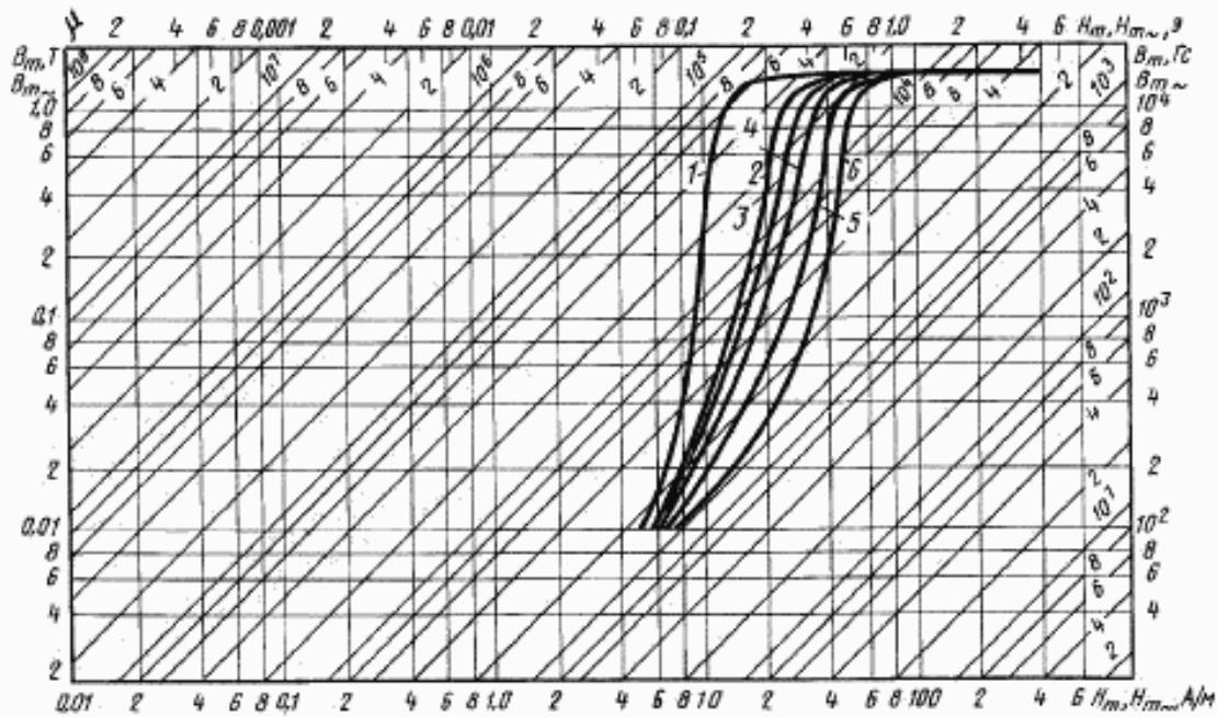
Кривые намагничивания сплава марки 50НП толщиной 0,05 мм для частот:
