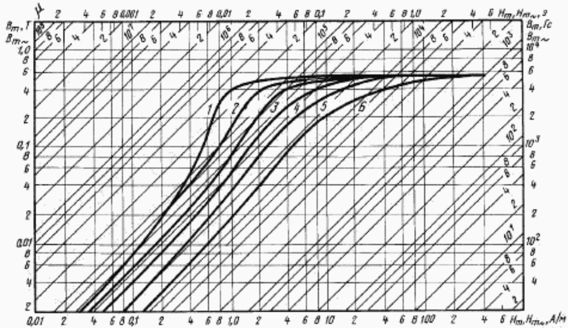
Кривые намагничивания сплава марки 81НМА толщиной 0,1 мм для частот:
