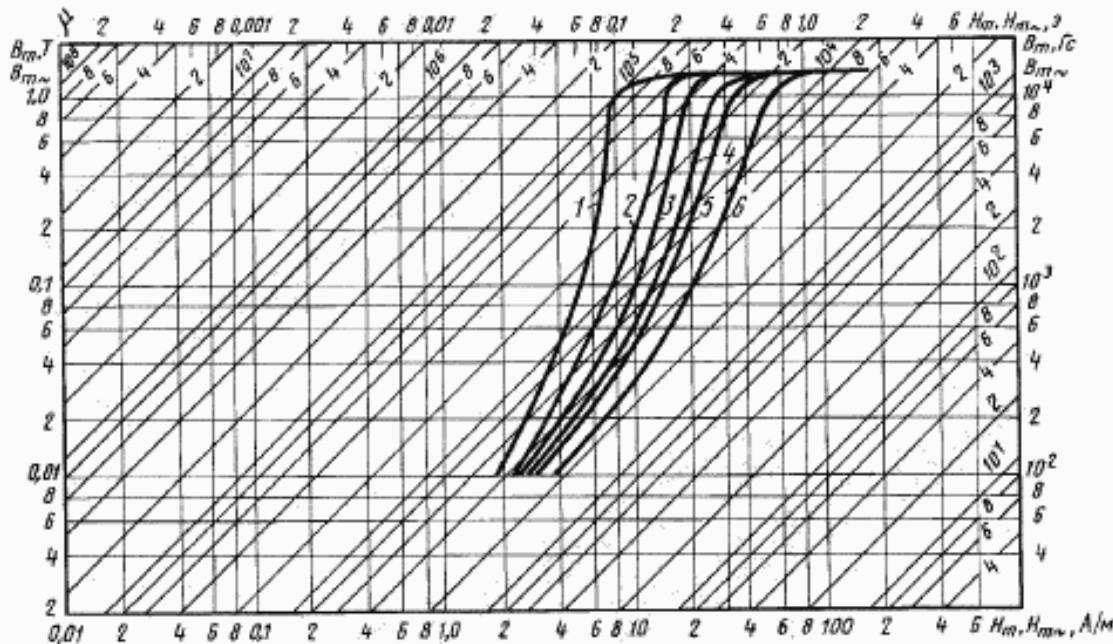
Кривые намагничивания сплава марки 34НКМП толщиной 0,05 мм для частот:
