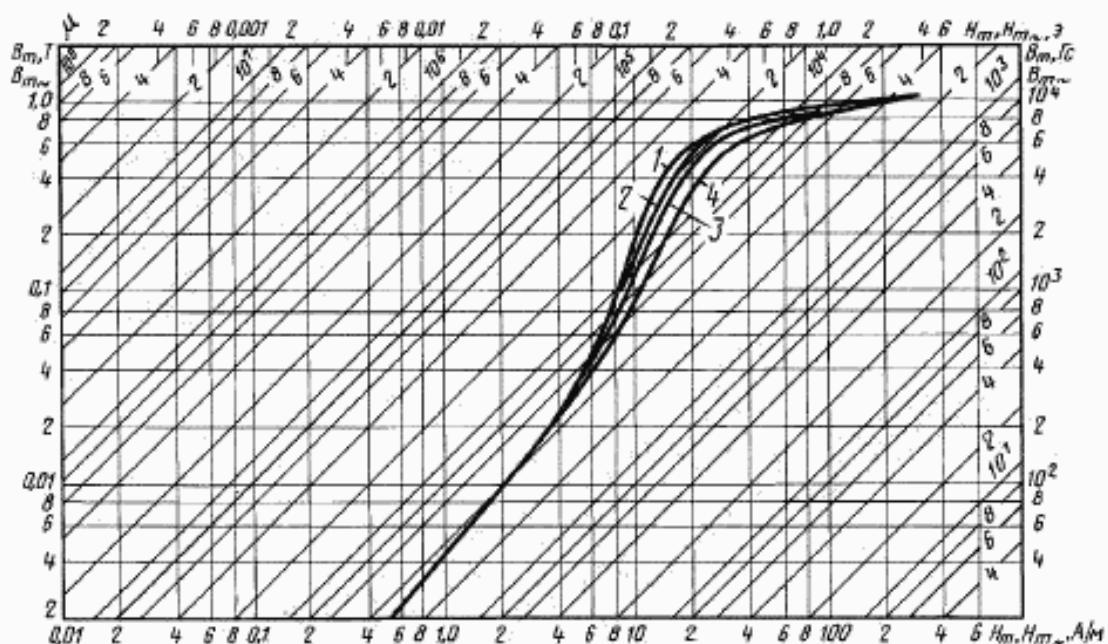
Кривые намагничивания сплава марки 50НХС толщиной 0,05 мм для частот:
