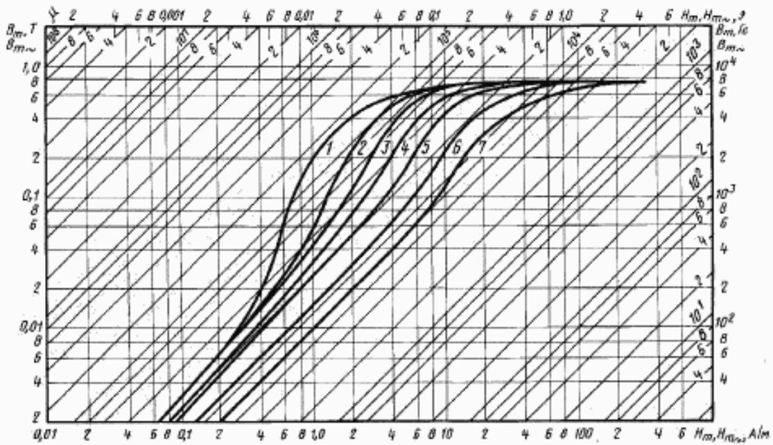
Кривые намагничивания сплава марки 79НМ толщиной 0,1 мм для частот:
