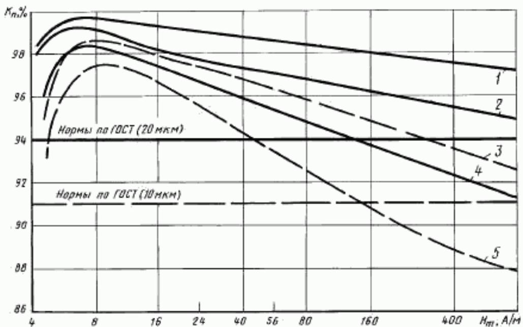
Зависимость коэффициента прямоугольности  $K_r$  от напряженности намагничивающего поля для сплава 50НП с разными значениями прямоугольности
