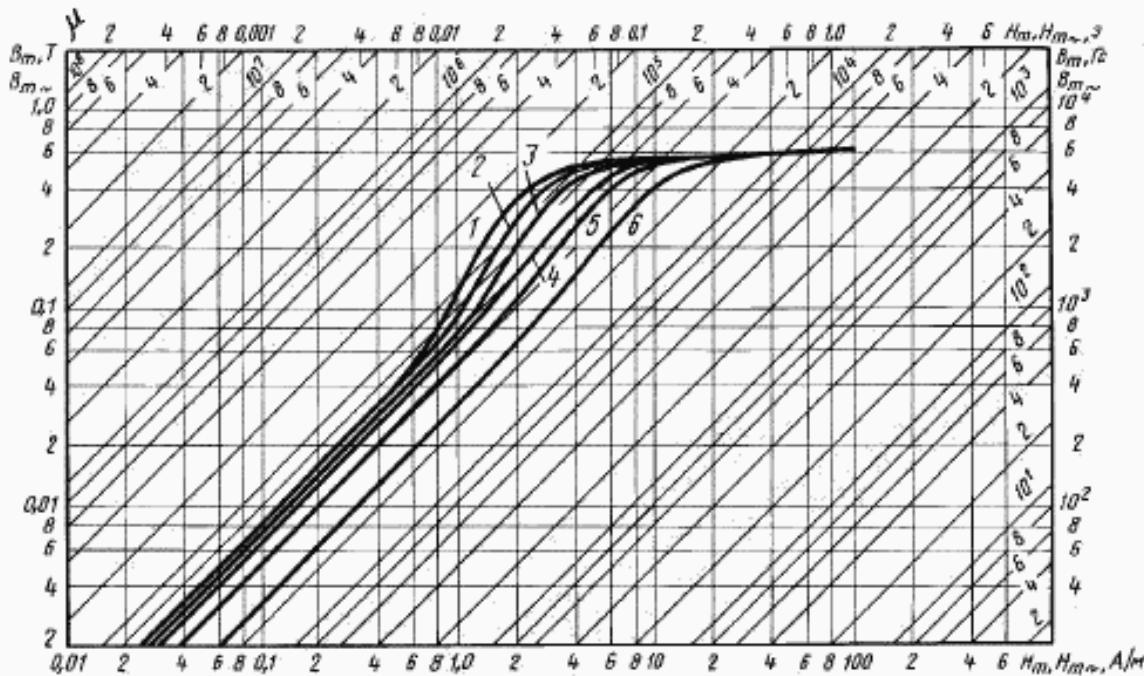
Кривые намагничивания сплава марки 83НФ толщиной 0,05 мм для частот:
