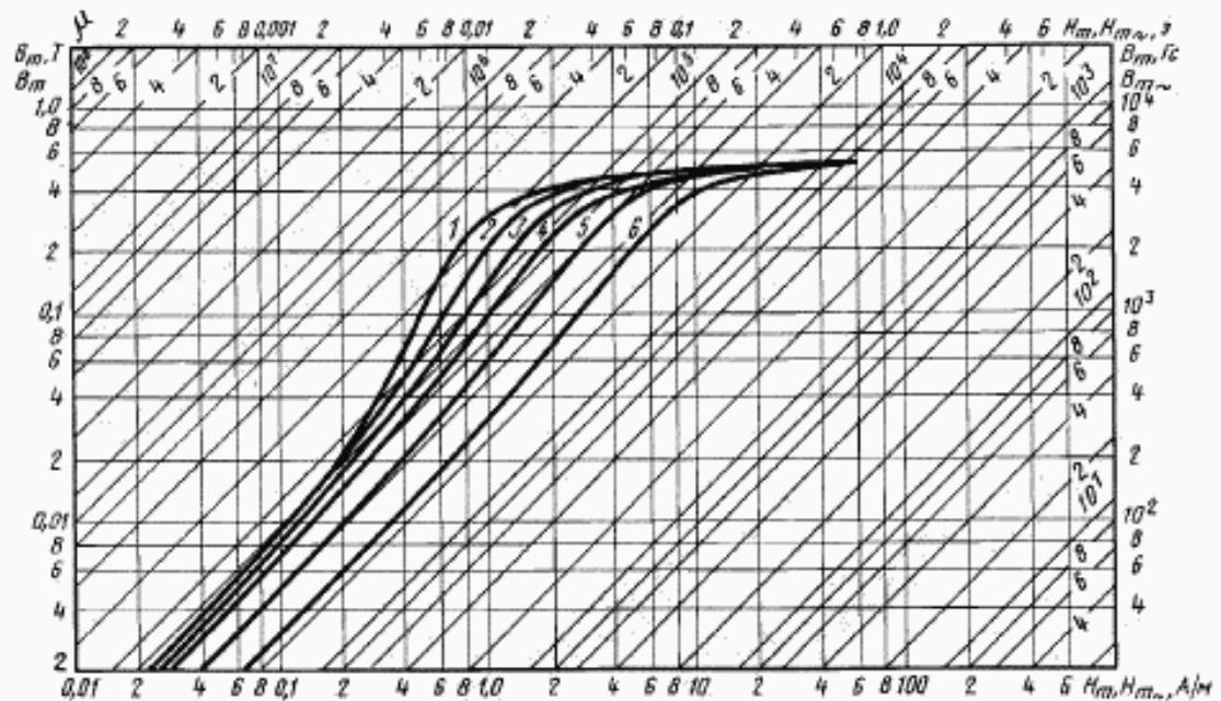
Кривые намагничивания сплава марки 81НМА толщиной 0,05 мм для частот:
