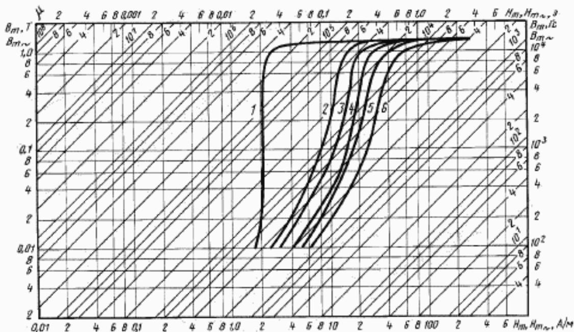
Кривые намагничивания сплава марки 40НКМП толщиной 0,05 мм для частот:
