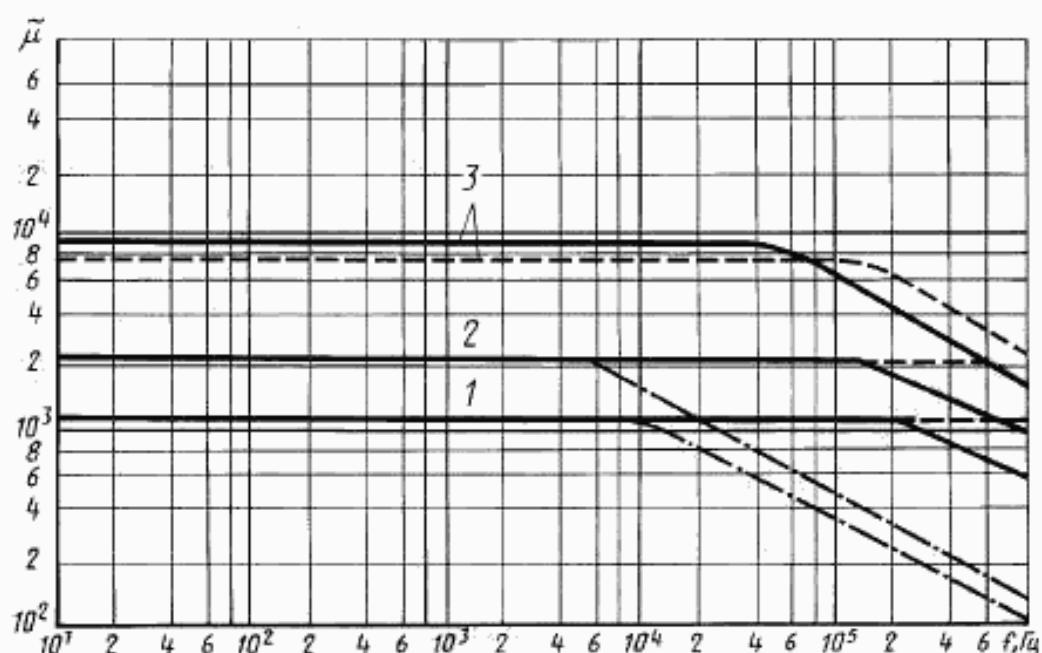
Зависимость начальной проницаемости от частоты для образцов из сплавов марок:
