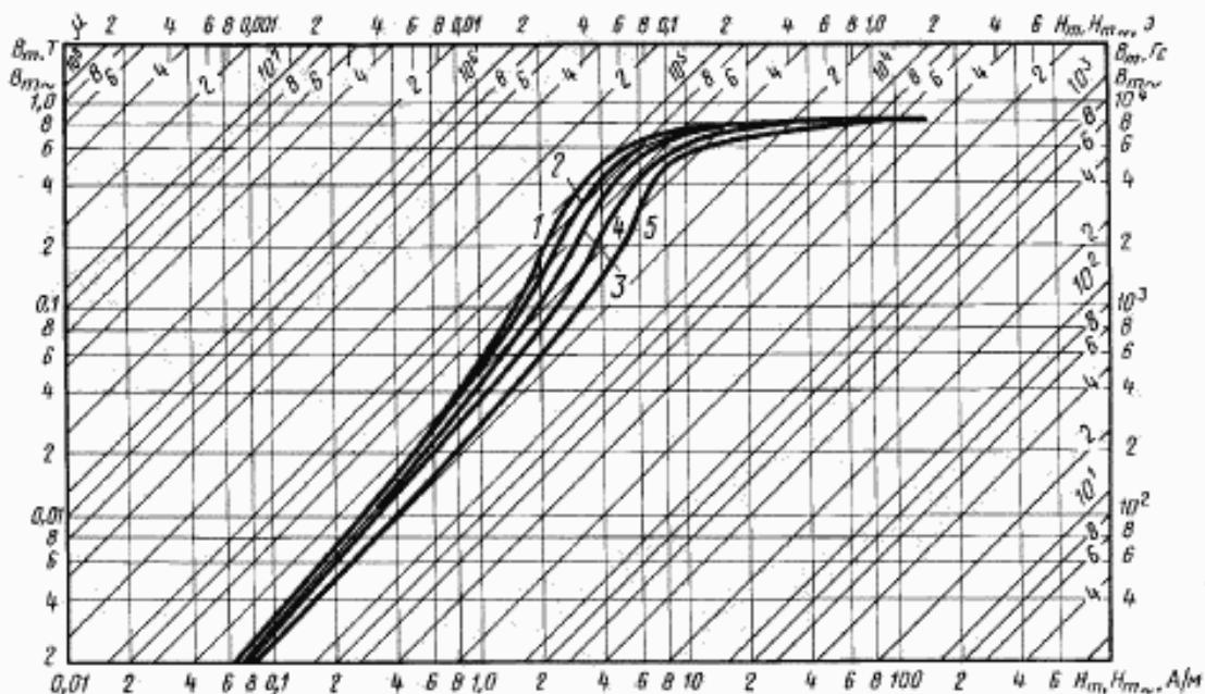
Кривые намагничивания сплава марки 79НМ толщиной 0,02 мм для частот:
