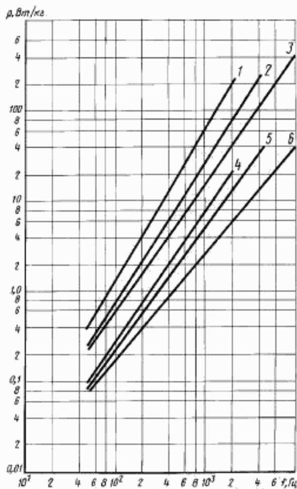
Зависимость  $P_{10}$  от частоты для сплавов марок 50Н:
