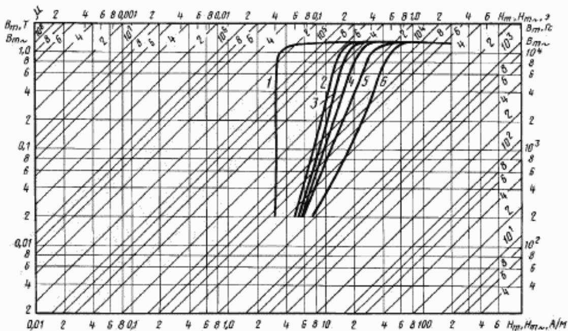
Кривые намагничивания сплава марки 35НКХСП толщиной 0,05 мм для частот:
