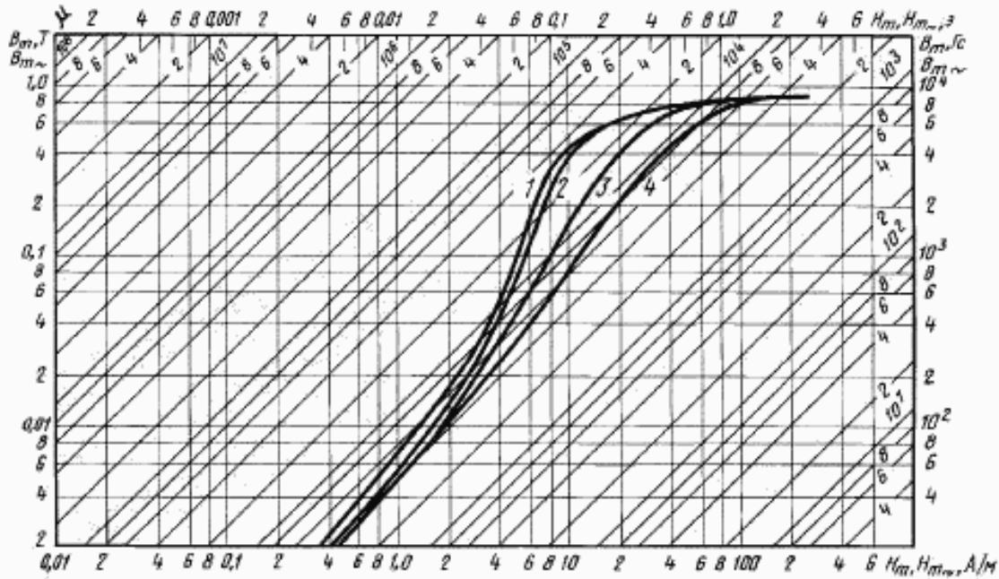
Кривые намагничивания сплава марки 50HXC толщиной 0,35 мм для частот:
