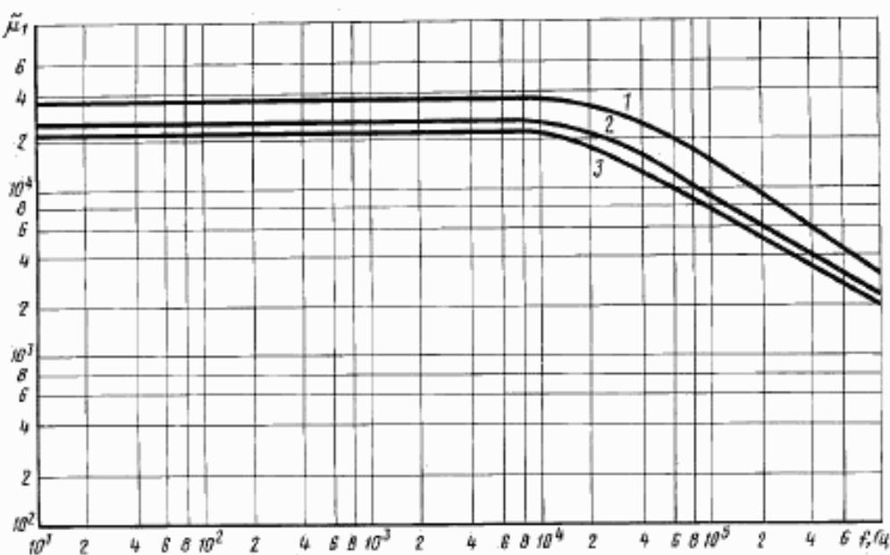
Зависимость  $\tilde{\mu}$  от частоты для сплавов в лентах толщиной 0,02 мм марок:
