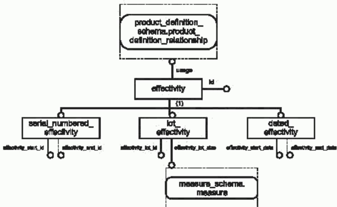
Рисунок F.15 — `effectivity_schema` — EXPRESS-G диаграмма 1 из 1
