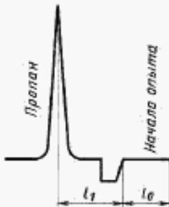
$l_0$  — расстояние от начала опыта до начала выхода отрицательного пика, мм;
