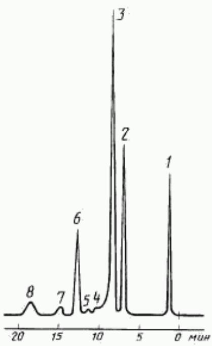
1 — воздух; 2 — изобутан; 3 — н-бутан; 4 — бутен-1; 5 — изобутен; 6 — транс-бутен-2 + 2,2-диметилпропан; 7 — цис-бутен-2; 8 — изопентан
