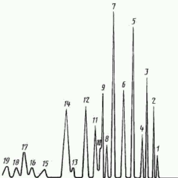
1 — воздух + метан; 2 — этан + этен; 3 — пропан; 4 — пропен; 5 — изобутан; 6 — н-бутан; 7 — бутен-1; 8 — изобутен; 9 — транс-бутен-2; 10 — бутадиен-1,3; 11 — цис-бутен-2; 12 — изопентан; 13 — 3-метилбутен-1; 14 — н-пентан; 15 — пентен-1; 16 — 2-метилбутен-1; 17 — транс-пентен-2; 18 — цис-пентен-2; 19 — 2-метилбутен-2
