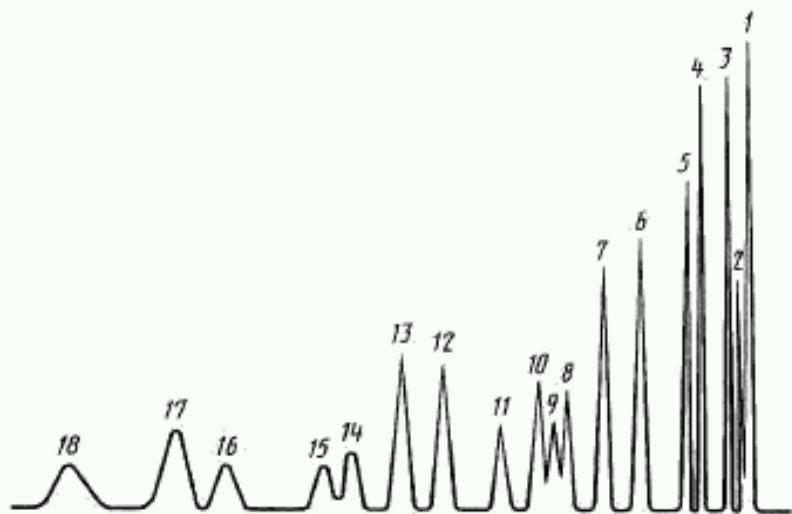
1 — воздух; 2 — метан; 3 — этан+этен; 4 — пропан; 5 — пропен; 6 — изобутан; 7 — н-бутан; 8 — бутен-1; 9 — изобутен; 10 — транс-бутен-2; 11 — цис-бутен-2; 12 — бутадиен-1,3; 13 — изопентан; 14 — 3-метилбутен-1; 15 — н-пентан; 16 — пентен-1; 17 — 2-метилбутен-1 + транс-пентен-2; 18 — цис-пентен-2
