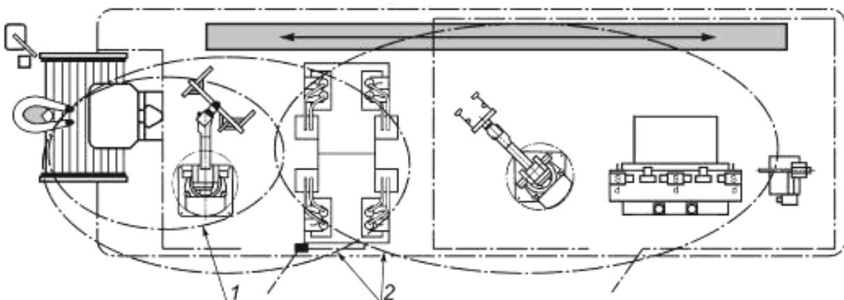
1 — область управления светом; 2 — область управления блокирующим устройством
