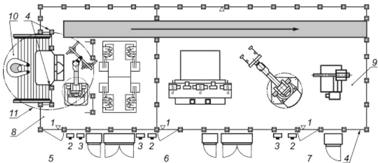
1 — блокировка прохода; 2 — аварийная остановка; 3 — переустановка; 4 — предохранение по периметру; 5 — доступ закрыт; 6 — доступ открыт; 7 — зона А; 8 — зона В; 9 — зона С; 10 — зона С; 11 — сенсорное устройство постоянного обнаружения присутствия
