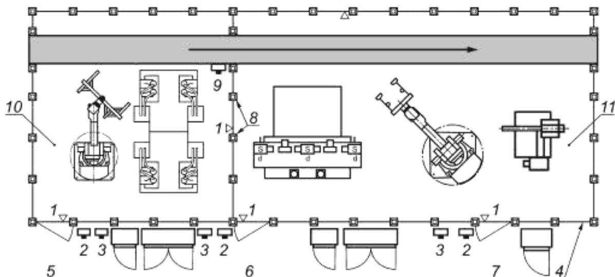
1 — блокировка подхода; 2 — аварийная остановка; 3 — переустановка; 4 — предохранение по периметру; 5 — доступ закрыт; 6 — доступ закрыт; 7 — доступ закрыт; 8 — доступ закрыт; 9 — аварийные остановки конвейера; 10 — зона А; 11 — зона В
