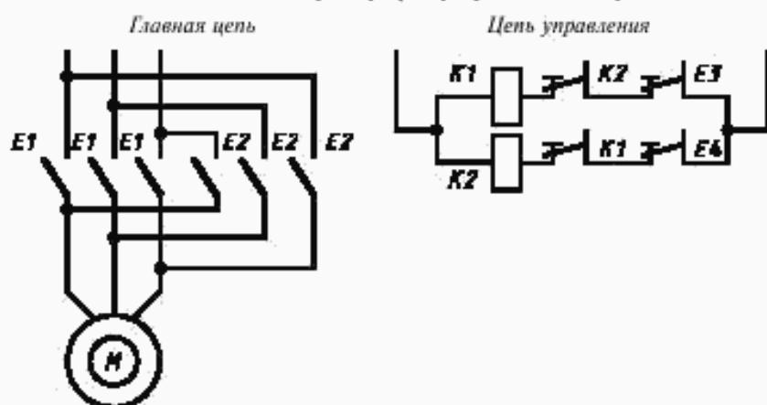
*K1, K2 — испытуемые контакторы; E3, E4 — контакты вспомогательного аппарата;
