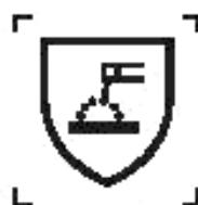
Рисунок 1 — Пиктограмма защиты от рисков при сварочных работах (ISO 7000-2683)
