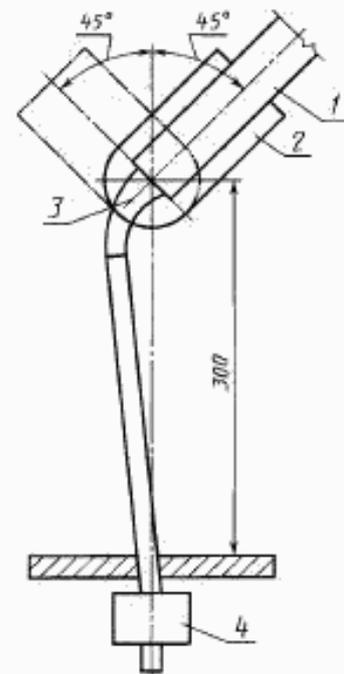
1 — часть машины; 2 — колеблющаяся часть; 3 — ось качения; 4 — груз
