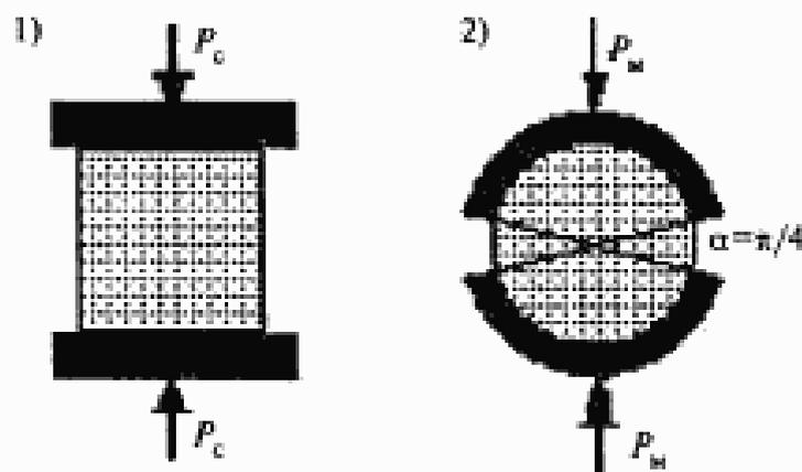
Рисунок 9 — Схема испытания образцов на сдвигоустойчивость
