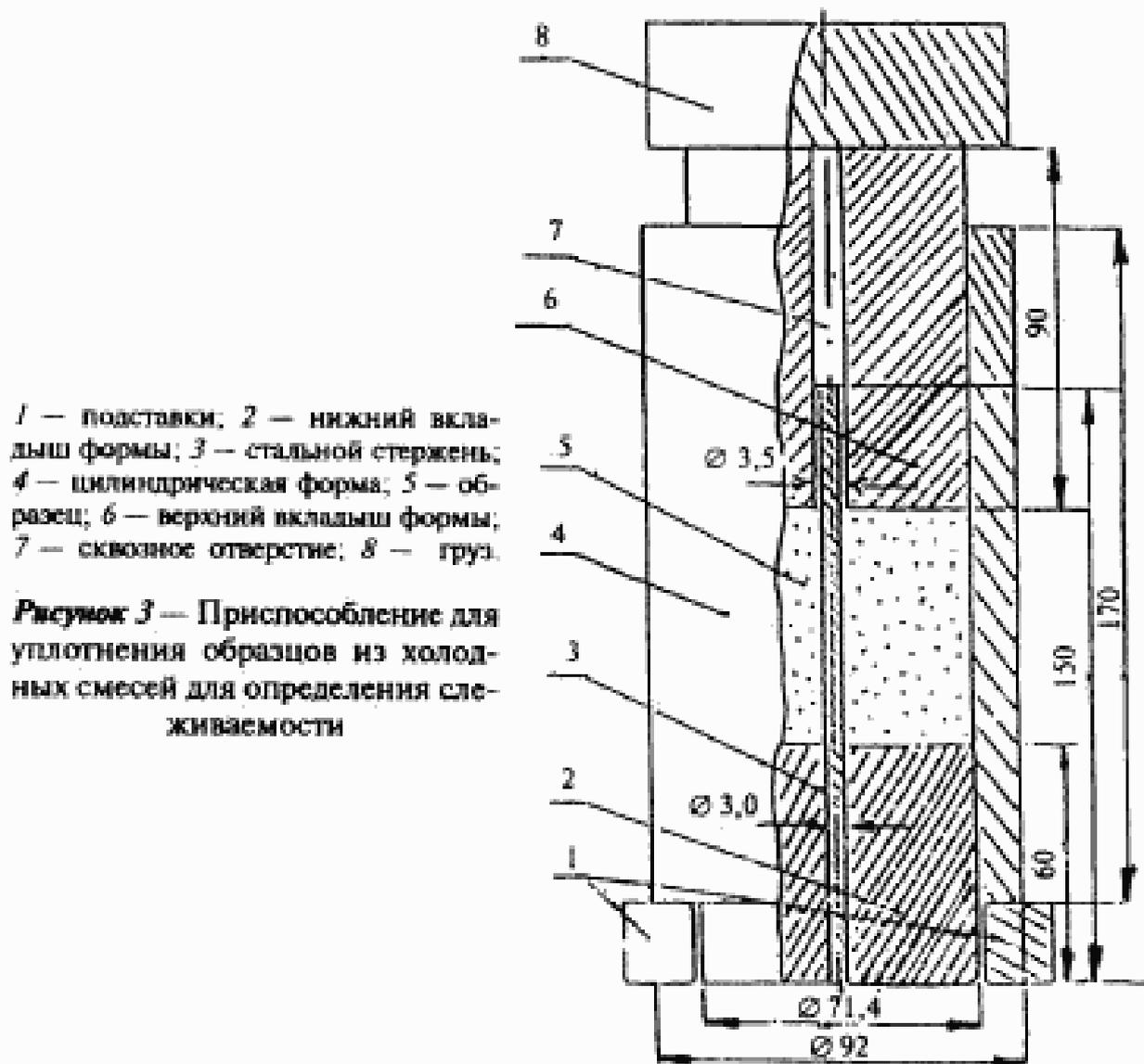
1 — подставки; 2 — нижний вкладыш формы; 3 — стальной стержень; 4 — цилиндрическая форма; 5 — образец; 6 — верхний вкладыш формы; 7 — сквозное отверстие; 8 — груз.
