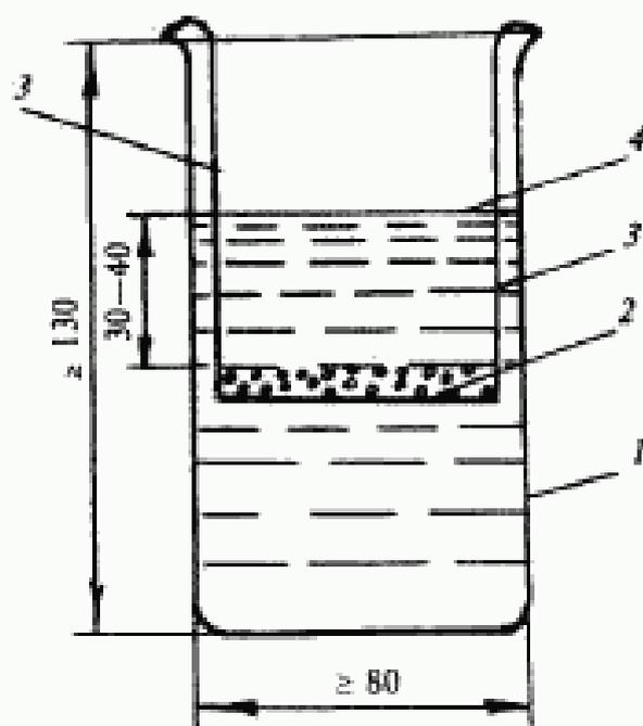
Рисунок 12 — Схема испытания для определения сцепления вяжущего с минеральной частью смеси
