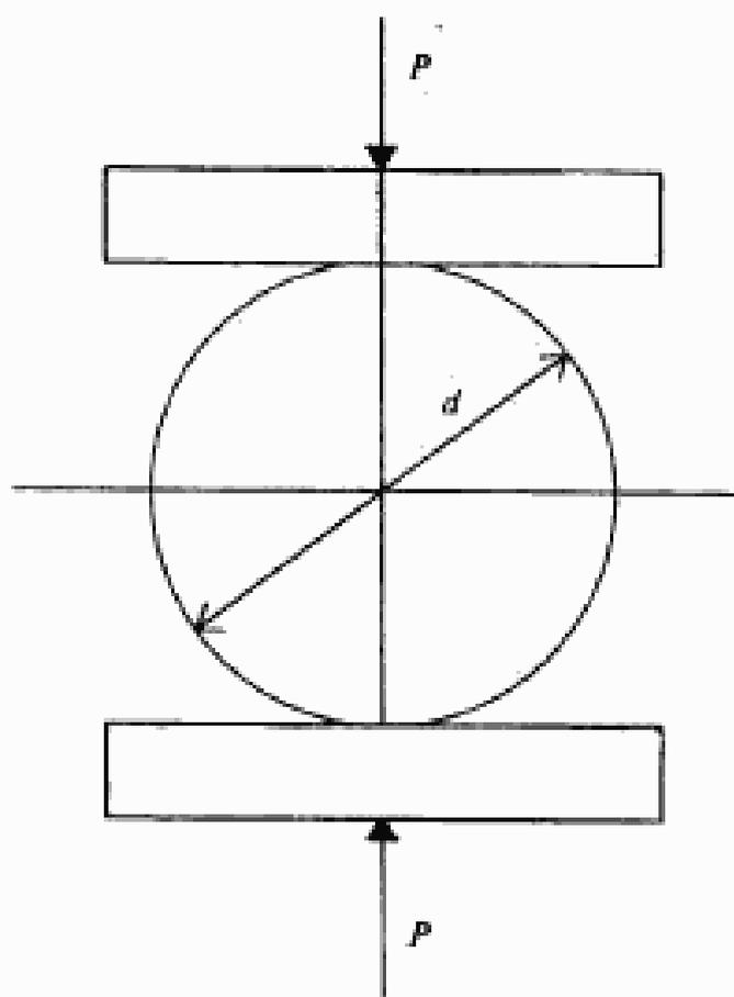
Рисунок 7 — Схема испытания образцов на растяжение при расколе
