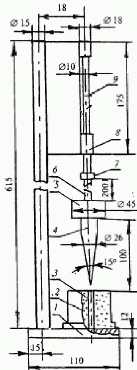
Рисунок 13 — Прибор для определения слеживаемости
