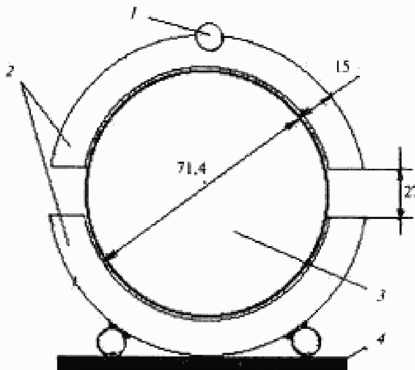
1 — шарнир; 2 — цилиндрические обоймы; 3 — образец; 4 — нижняя плита прессы
