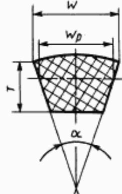
$W_p$  — расчетная ширина ремня, мм;  $W$  — ширина большого основания ремня, мм;  $T$  — высота ремня, мм;  $\alpha$  — угол клина ремня, равный  $(40\pm 1)^\circ$
