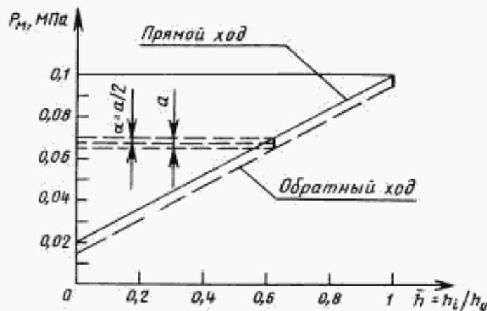
В случае неудовлетворительных результатов испытаний для клапанов, укомплектованных позиционером, допускается испытание на нечувствительность проводить с подключенным позиционером, при этом значение нечувствительности не должно превышать 2% максимальной величины входного (командного) сигнала.
