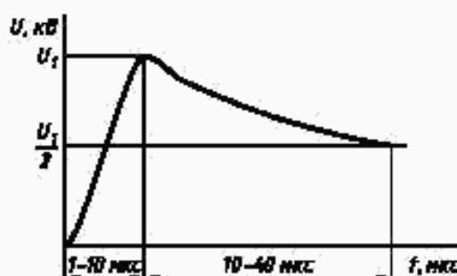
Рисунок Д.4 — Форма грозовых импульсов, характерная для точек присоединения *b*, *e*, *z* на рисунке Д.1.
