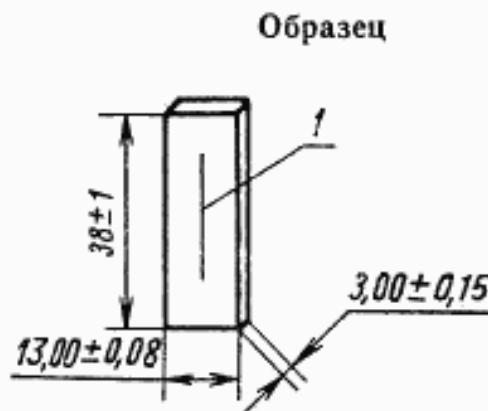
*J*—надрез длиной  $(19,0 \pm 0,5)$  мм глубиной  $0,5 \pm 0,05$  мм
