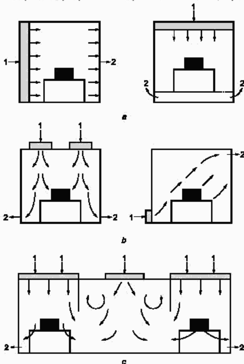
a — однонаправленный поток воздуха; b — неоднонаправленный поток воздуха; c — смешанный поток воздуха;
