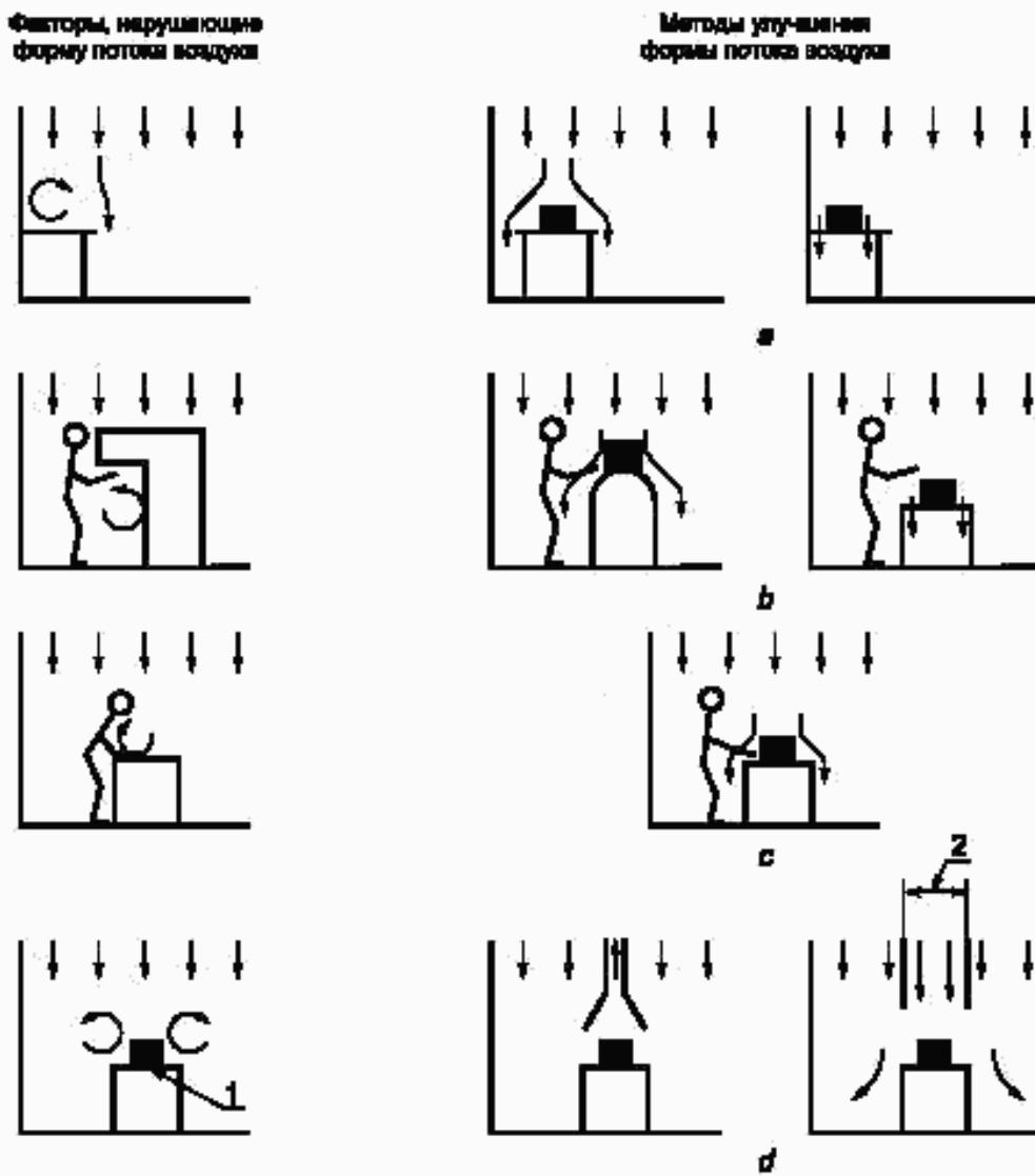
a — за счет лучшего расположения оборудования; b — за счет лучшей формы оборудования и рабочего места; c — за счет правильного поведения персонала; d — за счет специальной организации потоков воздуха; 1 — источник тепла; 2 — локальный поток с повышенной скоростью
