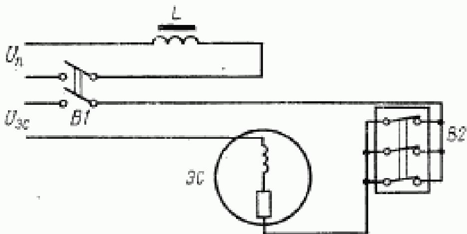
$L$  — отключающая катушка привода;  $U_n$  — напряжение на зажимах привода;  $U_{3c}$  — напряжение электросекундомера;  $B1$  — тумблер;  $B2$  — испытуемый коммутационный аппарат
