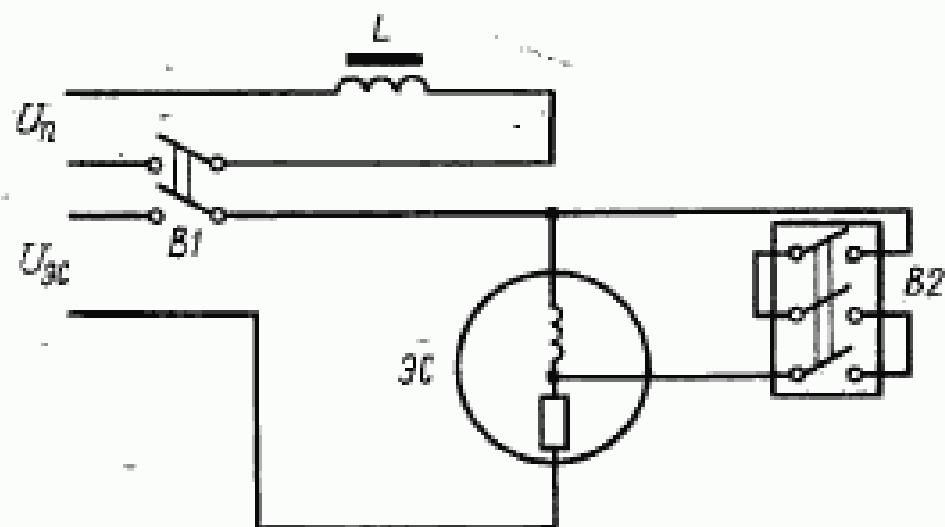
$L$  — катушка контактора — для электромагнитного привода (выключатель катушки — для других типов привода);  $R_C$  — электросекундомер;  $B1$  — тумблер;  $B2$  — испытуемый коммутационный аппарат.
