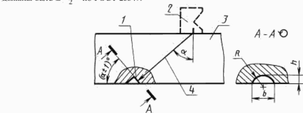
1 — плоскость сегментного отражателя; 2 — преобразователь;
