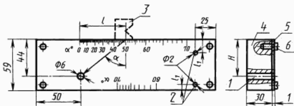
1 — отверстие для определения угла ввода луча, ширины основного лепестка диаграммы направленности, условной и предельной чувствительности; 2 — отверстие для проверки мертвых зон; 3 — преобразователь; 4 — блок из контролируемого металла; 5 — шкала; 6 — винт
