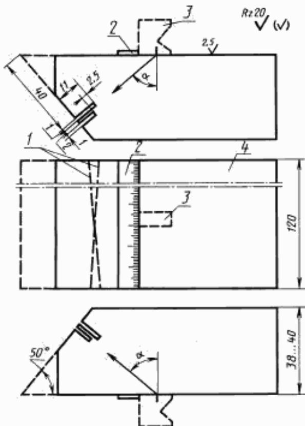
1 — пазы; 2 — линейка; 3 — преобразователь; 4 — блок из стали марки 20 по ГОСТ 1050 или стали марки 3 по ГОСТ 14637; разность глубины пазов на концах образца ( $h$ ); ширина образца ( $l$ )
