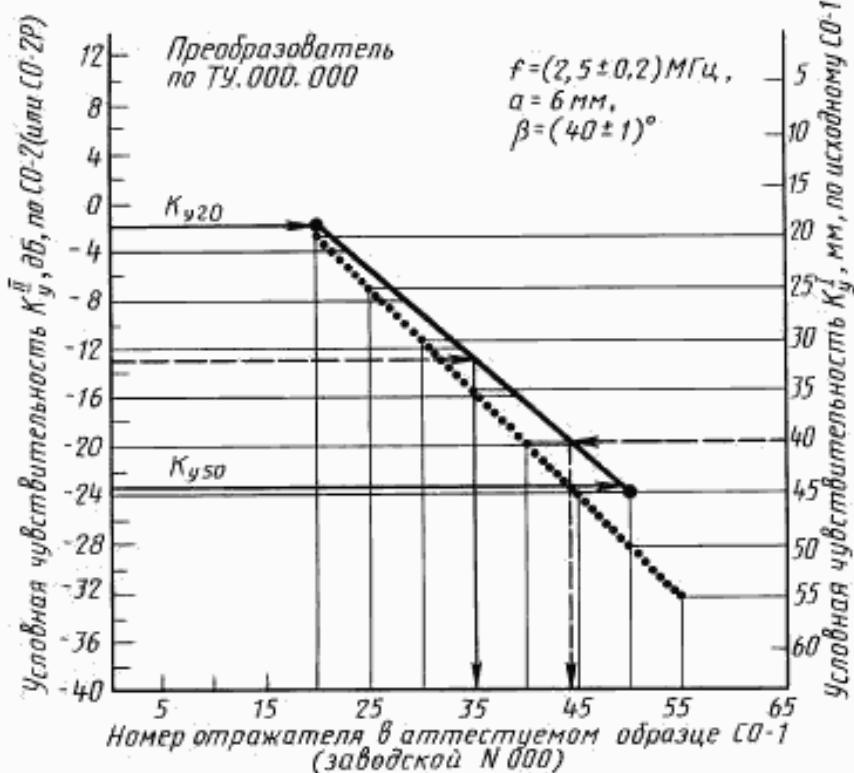
Для построения соответствующего графика к конкретному аттестуемому образцу СО-1, не соответствующему требованиям п. 1.4.1 настоящего стандарта, при указанных выше условиях определяют в децибелах разности  $K$  амплитуд  $N$  от отражателей № 20 и 50 диаметром 2 мм в аттестуемом образце и амплитуды  $N_i$  от отражателя диаметром 6 мм на глубине 44 мм в образце СО-2 (или СО-2Р):
