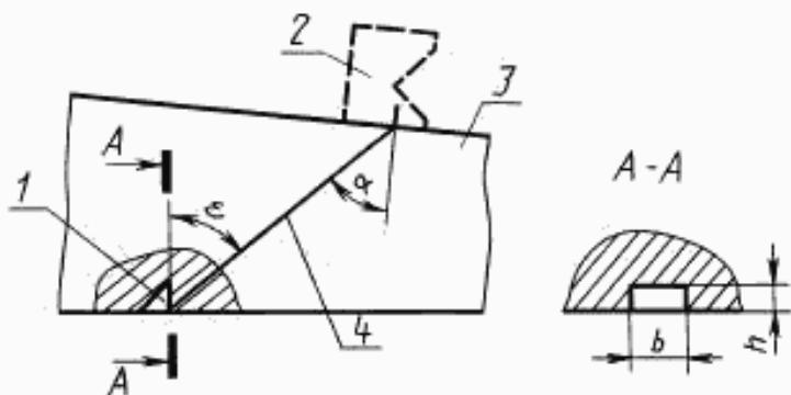
1 — плоскость углового отражателя; 2 — преобразователь;
