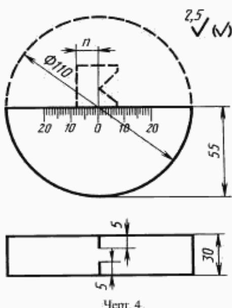
Стандартный образец СО-3 изготавливают из стали марки 20 по ГОСТ 1050 или стали марки 3 по ГОСТ 14637. Скорость распространения продольной волны в образце при температуре  $(20 \pm 5)$  °С должна быть  $(5900 \pm 59)$  м/с. Измеренное с погрешностью не хуже 0,5% значение скорости должно быть указано в паспорте на образец.
