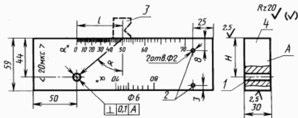
1 — отверстие для определения угла ввода луча, ширины основного лепестка диаграммы направленности, условной и предельной чувствительности; 2 — отверстие для проверки мертвых зон; 3 — преобразователь; 4 — блок из стали марки 20 или стали марки 3
