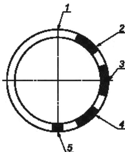
1 — верх неподвижной трубы; 2 — область для вырезки одного образца для испытаний на растяжение и образцов для испытаний на изгиб и на излом; 3 — область для вырезки дополнительных образцов, если предписано; 4 — область для вырезки одного образца для испытаний на растяжение и образцов для испытаний на изгиб и на излом; 5 — область для вырезки одного образца для макроскопических исследований и одного образца для микроскопических исследований
