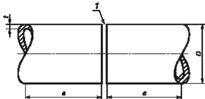
1 — подготовка и сборка соединения, как описано в рWPS; а — минимальное значение 150 мм; D — наружный диаметр трубы;
