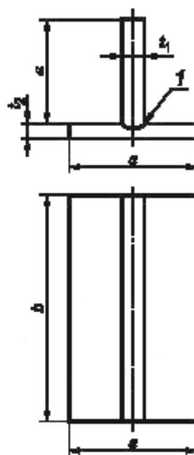
1 — сварной шов с одной или обеих сторон. Подготовка и сборка соединения, как описано в рWPS; а — минимальное значение 150 мм; b — минимальное значение 300 мм; t — толщина материала
