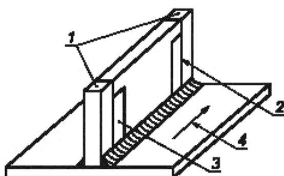
1 — нерассматриваемая область 25 мм; 2 — область для вырезки образцов для макроскопических и микроскопических исследований; 3 — область для вырезки одного образца для макроскопических исследований; 4 — направление сварки
