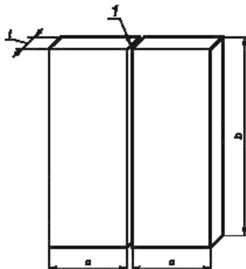
1 — подготовка и сборка соединения, как описано в pWPS;  $a$  — минимальное значение 150 мм (образцы для испытаний на поперечный изгиб могут иметь большее значение  $a$ , см. 7.4);  $b$  — минимальное значение 300 мм;  $t$  — толщина материала
