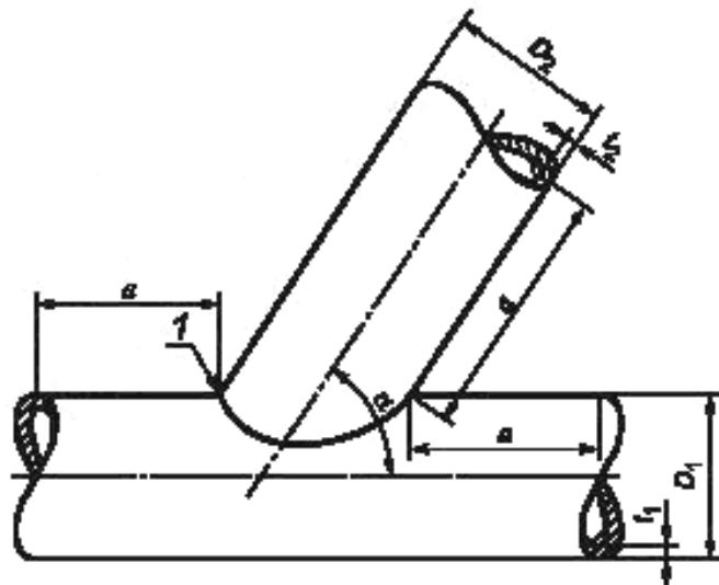
1 — подготовка и сборка соединения, как описано в pWPS;  $a$  — минимальное значение 150 мм;  $D_1$  — наружный диаметр трубы;  $D_2$  — наружный диаметр отвода;  $t_1$  — толщина материала основной трубы;  $t_2$  — толщина материала отвода;  $\alpha$  — угол отвода
