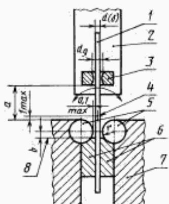
1 — испытуемый образец; 2 — изгибающий рычаг; 3 — поводок;
