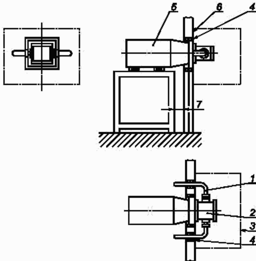
1 — трубопровод; 2 — испытуемый насос; 3 — измерительная поверхность; 4 — звукоизоляция из мягкой резины;
