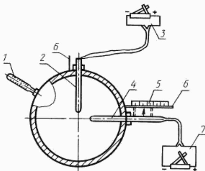
1 — термометр; 2, 4 — контрольная и рабочая наворотные трубки; 3, 7 — микроманометры для измерений динамического давления и контрольной и рабочих точках; 5 — линейка; 6 — стальной пруток
