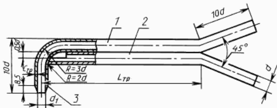
1, 2 — полости для измерения полного и статического давления; 3 — наконечник трубы
