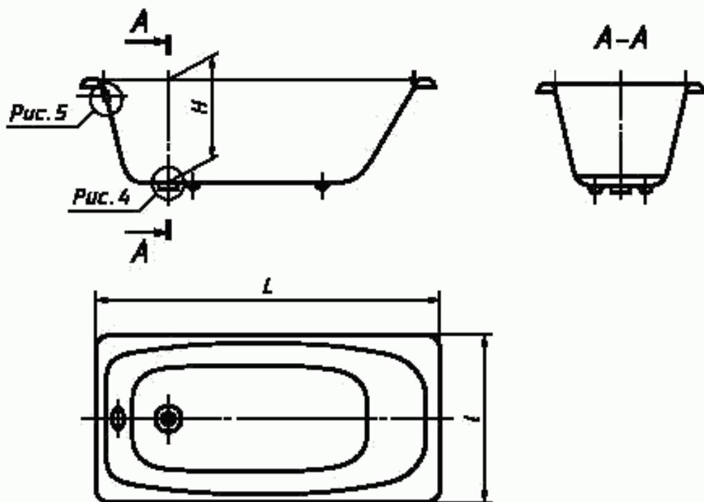
Рисунок 1 — Ванна чугунная эмалированная
