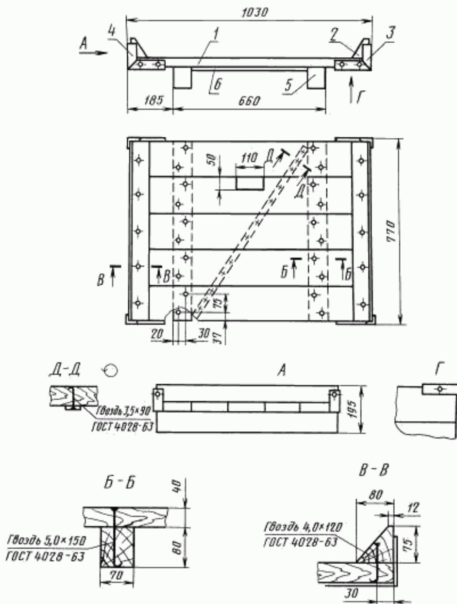
1 — настил; 2 — упор; 3 — уголок; 4 — уголок; 5 — опора; 6 — полоса
