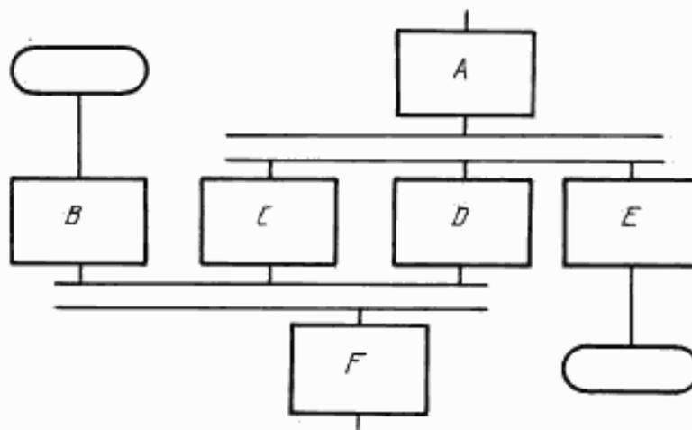
**Примечание.** Процессы C, D и E не могут начаться до тех пор, пока не завершится процесс A; аналогично процесс F должен ожидать завершения процессов B, C и D, однако процесс C может начаться и (или) завершиться прежде, чем соответственно начнется и (или) завершится процесс D.
