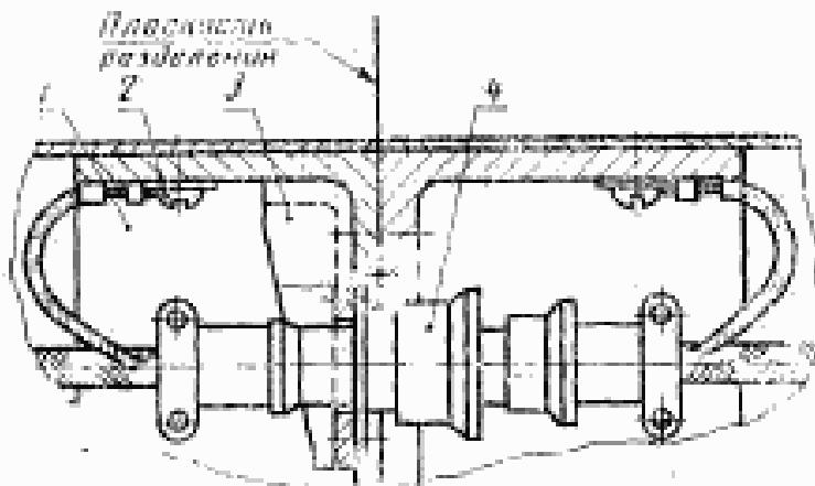
1 — проставка; 2 — винт; 3 — кронштейн; 4 — электрический соединитель.
