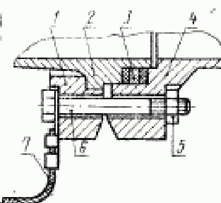
1 — наливной фланец трубопровода; 2 — трубопровод; 3 — прокладка; 4 — фланец; 5 — гайка; 6 — болт; 7 — неразъемная перемычка типа А по ГОСТ 18707
