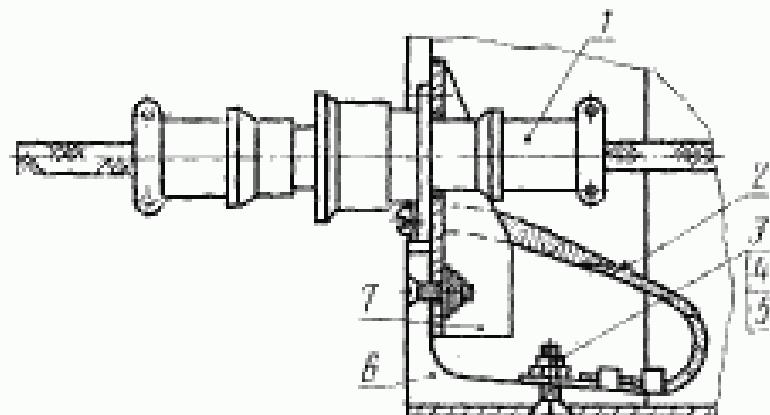
1 — электрический соединитель; 2 — перегибная перемычка типа А по ГОСТ 18707; 3 — контакт; 4 — гайка; 5 — шайба; 6 — шлангоут; 7 — кронштейн
