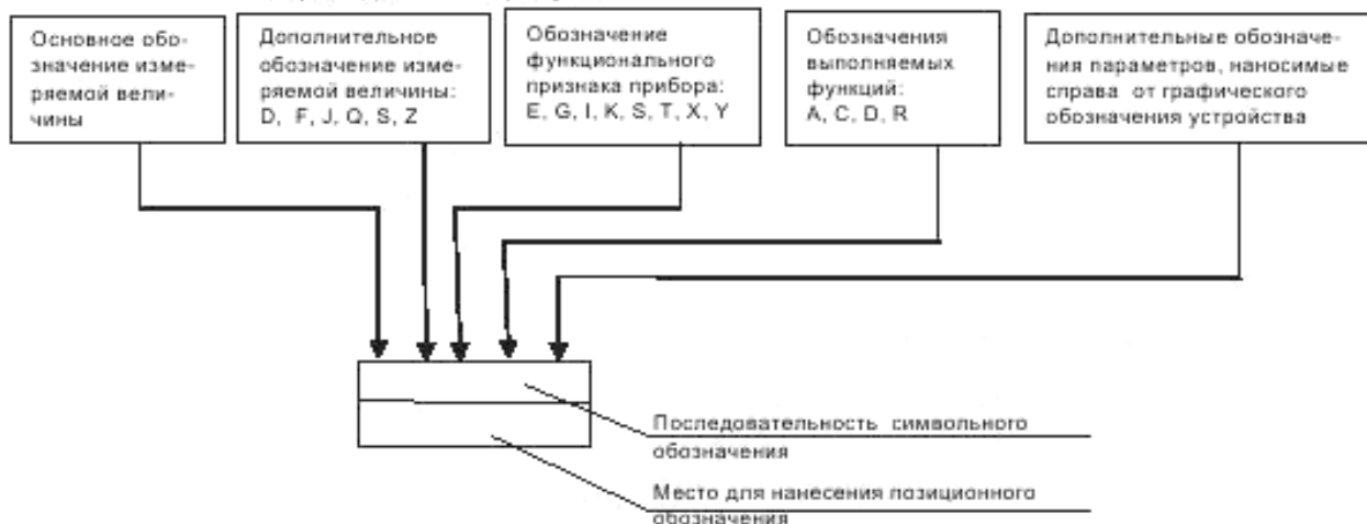
Рисунок 1 — Принцип построения условного обозначения прибора
