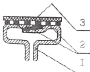
Клеевой шов ступенчатого дна с накладкой
