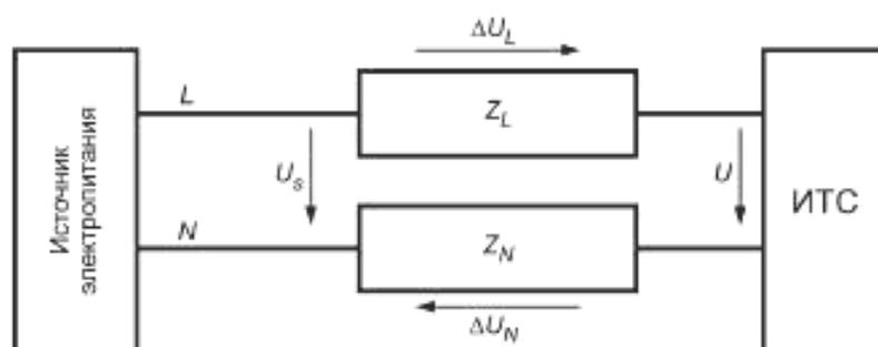
$U_s$  — напряжение «фаза — нейтраль» источника электропитания;  $U$  — напряжение на зажимах ИТС;  $Z_L$ ,  $Z_N$  — полные сопротивления проводов и входной цепи измерения тока;  $\Delta U$  — падение напряжения на сопротивлениях  $Z_L$ ,  $Z_N$  ( $\Delta U = \Delta U_L + \Delta U_N$ );
