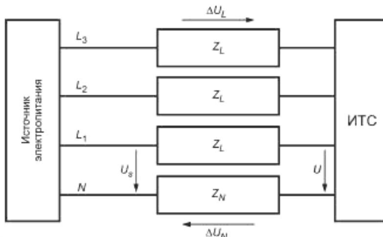
$U_s$  — напряжение кфаза — нейтраль источника электропитания;  $U$  — напряжение на зажимах ИТС;  $Z_L$ ,  $Z_N$  — полные сопротивления проводов и входной цепи измерения тока;  $\Delta U$  — падение напряжения на сопротивлениях  $Z_L$ ,  $Z_N$  ( $\Delta U = \Delta U_L + \Delta U_N$ );
