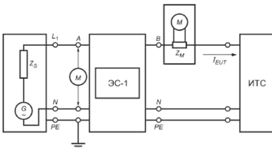
$G$  — источник электропитания;  $Z_S$  — внутреннее полное сопротивление источника электропитания;  $M$  — средство измерений; ЭС-1 — однофазный эквивалент сети;  $Z_M$  — внутреннее полное сопротивление средства измерений;  $I_{EUT}$  — потребляемый ток ИТС;  $L$  — фазный провод;  $N$  — нейтральный провод;  $PE$  — провод защитного заземления; ИТС — испытуемое техническое средство
