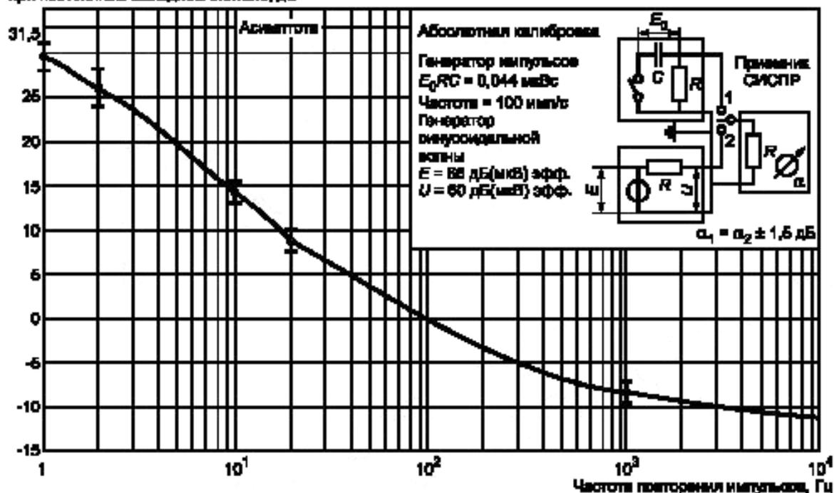
с) Импульсная характеристика ИП для полосы частот C/D (от 30 до 1000 МГц) и допустимые отклонения ее значений
