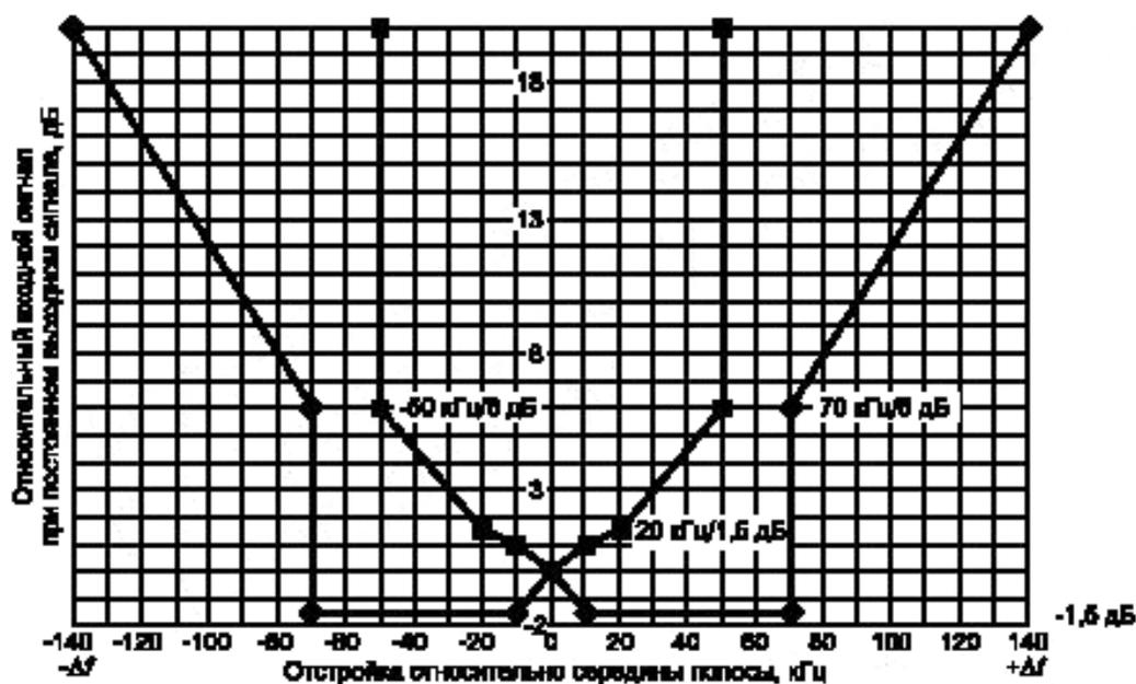
с) Пределы характеристики частотной избирательности ИП для полос частот С и Д (от 30 до 1000 МГц)
