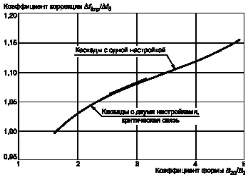
Рисунок Е.1 — Коэффициент коррекции для оценки отношения  $B_{\text{инп}}/B_{\text{с}}$  для других типов настраиваемых схем
