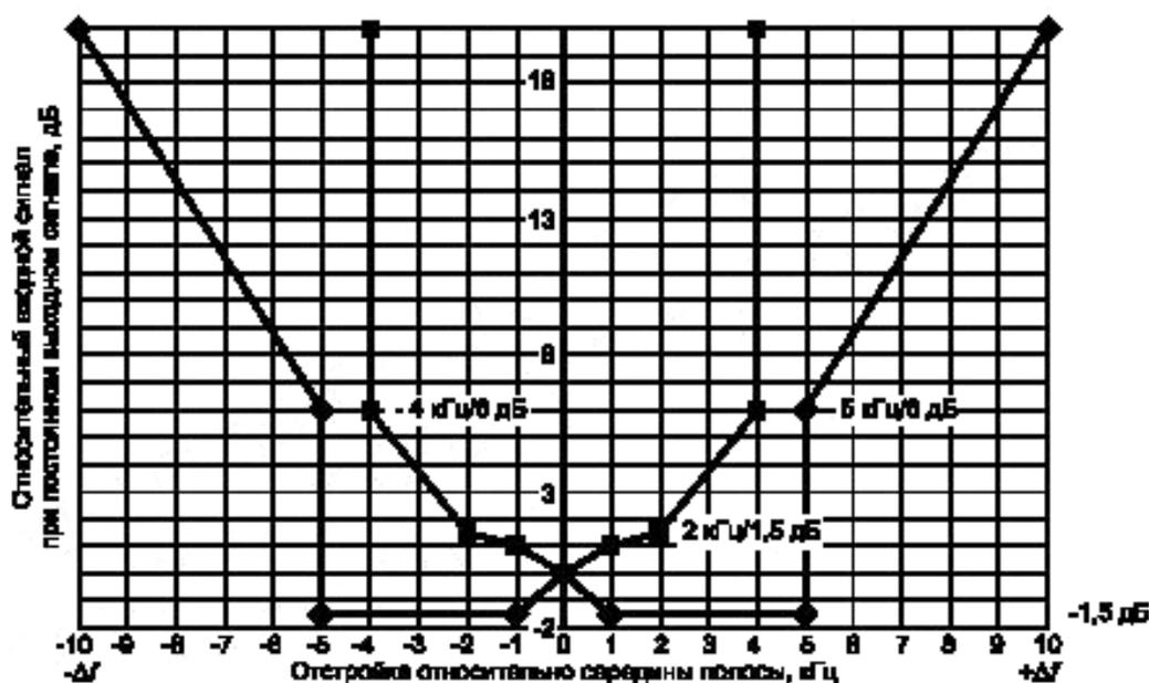
б) Пределы характеристики частотной избирательности ИП для полос частот В (от 0,15 до 30 МГц)
