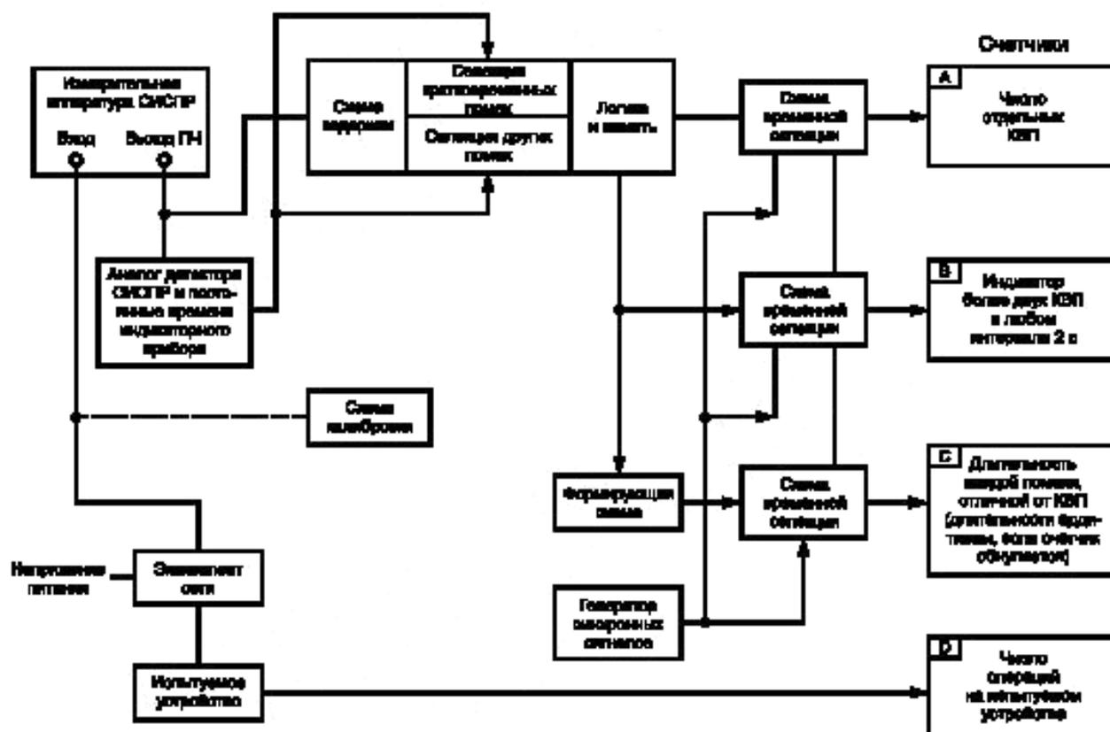
Рисунок 6 — Пример блок-схемы анализатора кратковременных ИПП
