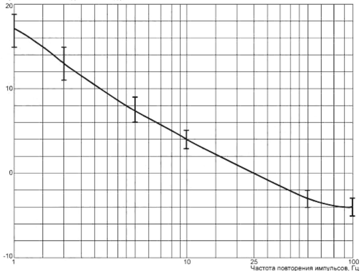
а) Импульсная характеристика ИРП для полосы частот А (от 9 до 150 кГц) и допускаемые отклонения ее значений
