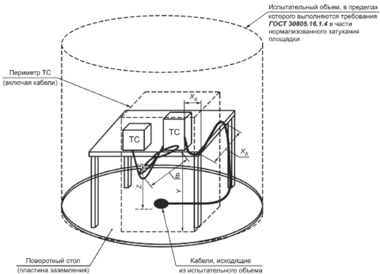
$X_a$  — длина горизонтального участка кабеля, перпендикулярного ТС, равная  $(0,2 \pm 0,02)$  м;  $X_b$  — длина горизонтального участка кабеля, параллельного ТС, равная  $(0,8 \pm 0,08)$  м;  $Y$  — длина вертикального участка кабеля, идущего от края стола к пластине заземления;  $Z$  — минимальное расстояние от соединительных кабелей, свисающих со стола, до пластины заземления, равное  $(0,4 \pm 0,04)$  м;  $B$  — длина плоской петли, равная 30—40 см (излишняя длина кабеля)
