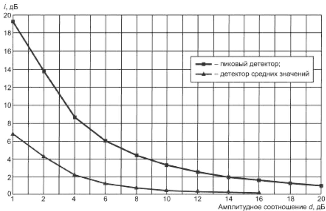
Рисунок А.11 — Зависимость коэффициента  $i$  от амплитудного соотношения  $d$  [см. формулы (A.6), (A.7), (A.9)]
