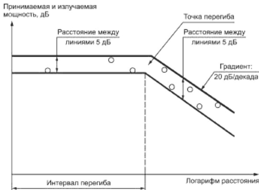
Рисунок 17 — Определение «интервала перегиба»
