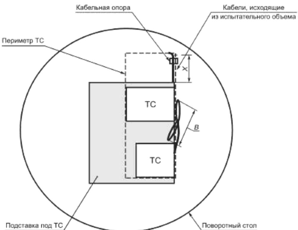
$X$  — длина горизонтального участка кабеля, равная  $(0,3 \pm 0,03)$  м;  $\vartheta$  — длина плоской петли, равная 1 м (излишняя длина кабеля)
