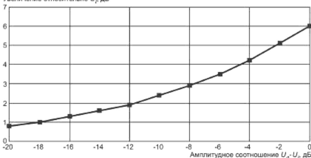
Рисунок А.10 — Увеличение пикового значения при суперпозиции двух немодулированных сигналов ( $U_a$  — уровень посторонних радиопомех;  $U_r$  — уровень ИРП, создаваемых испытуемым ТС)
