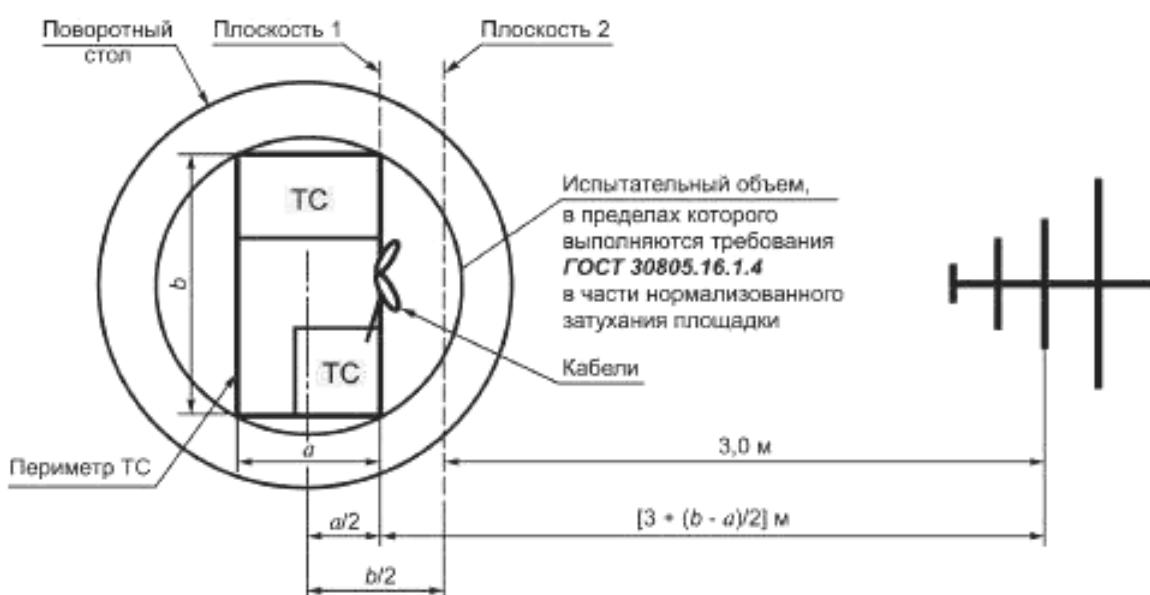
$a, b$  — размеры боковой и лицевой панелей испытуемого ТС
