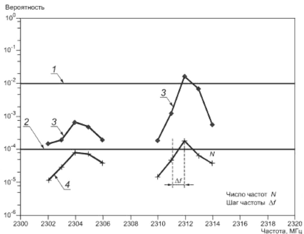
1 —  $P_{\min}$  при 60 дБ (1 мкВ/м); 2 —  $P_{\min}$  при 90 дБ (1 мкВ/м); 3 —  $P_{\max}$  при 60 дБ (1 мкВ/м); 4 —  $P_{\max}$  при 90 дБ (1 мкВ/м)
