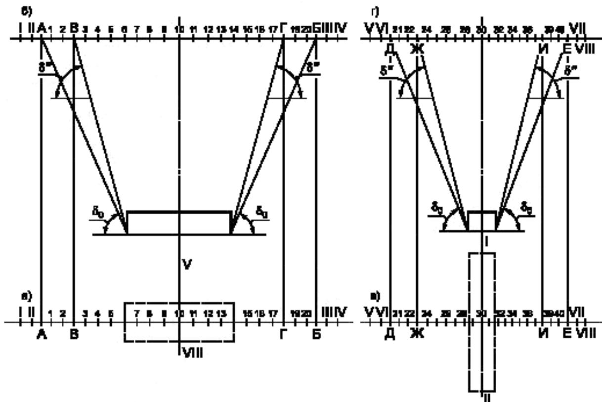
Рисунок Т.1 — Схема определения длин профильных линий при подземном способе строительства
