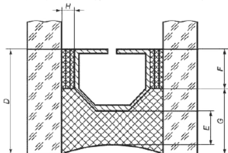
$D$  – общая глубина герметизирующих слоев;  $F$  – глубина первичного герметизирующего слоя;  $G$  – глубина вторичного герметизирующего слоя;  $E$  – глубина наружного герметизирующего слоя;  $H$  – толщина первичного герметизирующего слоя
