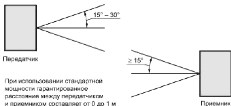
Рисунок А.1 — Угол зрения и расстояние для физического уровня IrDA
