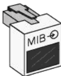
Рисунок D.4 — Инфракрасный адаптер для порта ПКС, соответствующего ИСО/ИИЭР 11073-30200
